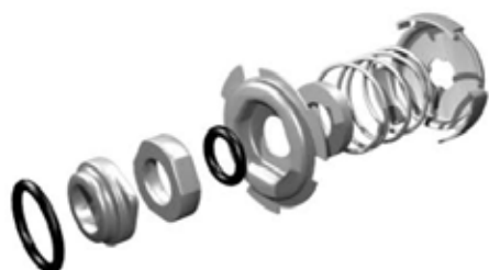
Fig. 14 Vista explodida do empanque
